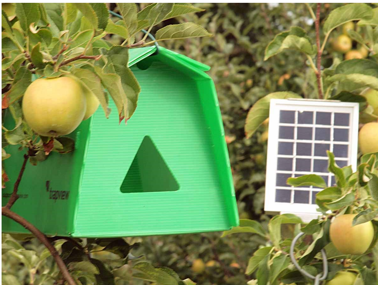
Obr. 55: Feromonový lapák Trapview s přenosem dat (převzato z trapview.com)
