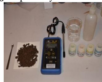
pH metr s kalibračními roztoky, upravený půdní vzorek, laboratorní kádinka a lžička
