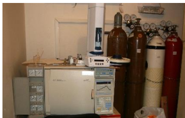
1. Laboratorní centrifuga 2. Plynový chromatograf s plamenionizačním detektorem, uprostřed autosampler, vpravo tlakové láhve (nosný plyn, vodík a kyslík pro detektor)
