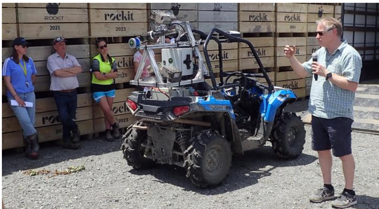
Obrázek 22. Čtyřkolka s kamerami a technologií společnosti Green Atlas pro hodnocení květní násady, případně dalších parametrů porostu.
