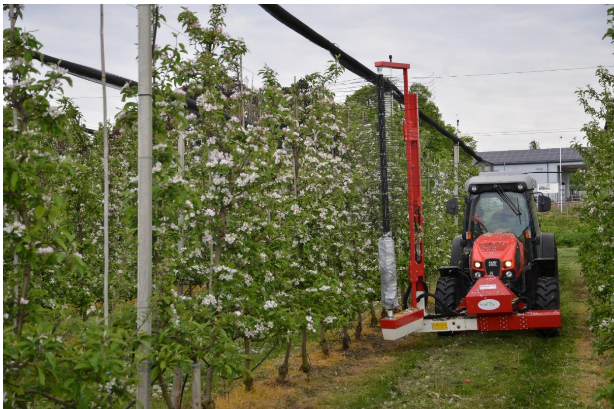
Obrázek 10. Upravené rotační vřeteno, kdy spodní část řemínků je stažena balicí strečovou fólií tak, aby nedocházelo k ometání spodní, méně nasazené části koruny.
